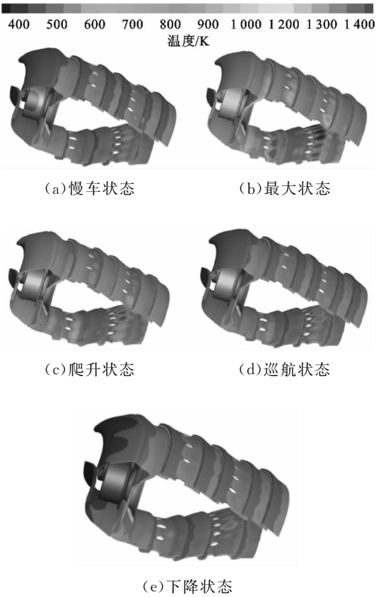
图 6 不同工况下燃烧室基体表面温度分布
